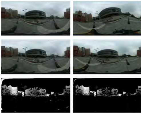
(그림 8) 정합 전 좌측 영상 및 우측영상(상단), 정합 후 좌측 영상 및 우측 영상(중간), 정합된 영상으로부터 구해진 좌측 및 우측 거리 영상(하단)
