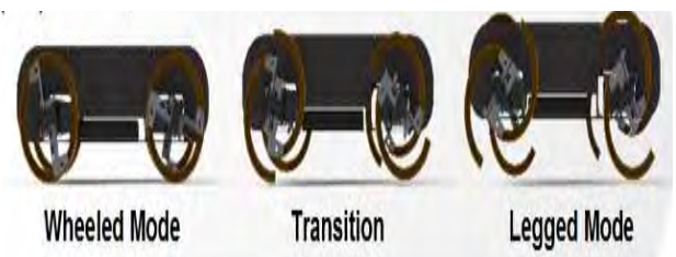
(그림 2) Turboquad 휠 변형 과정
