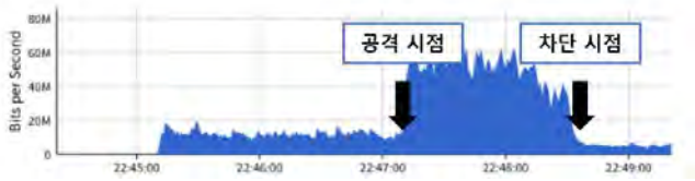
(그림 6) IP Flow 기반 차단 기법 적용 결과
