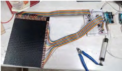
(그림 5) 완성된 FSR Array
