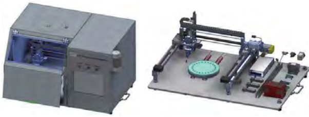
(그림 2) 이어핀 삽입 자동화 시스템
